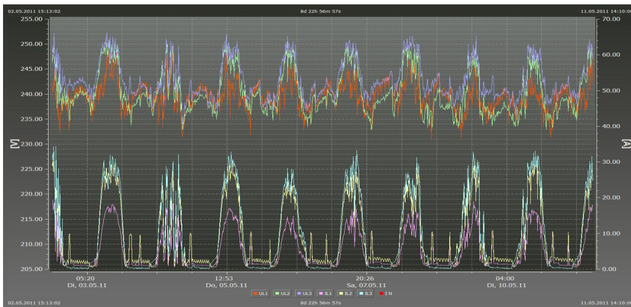
电压，电流 3 相+中性导线
